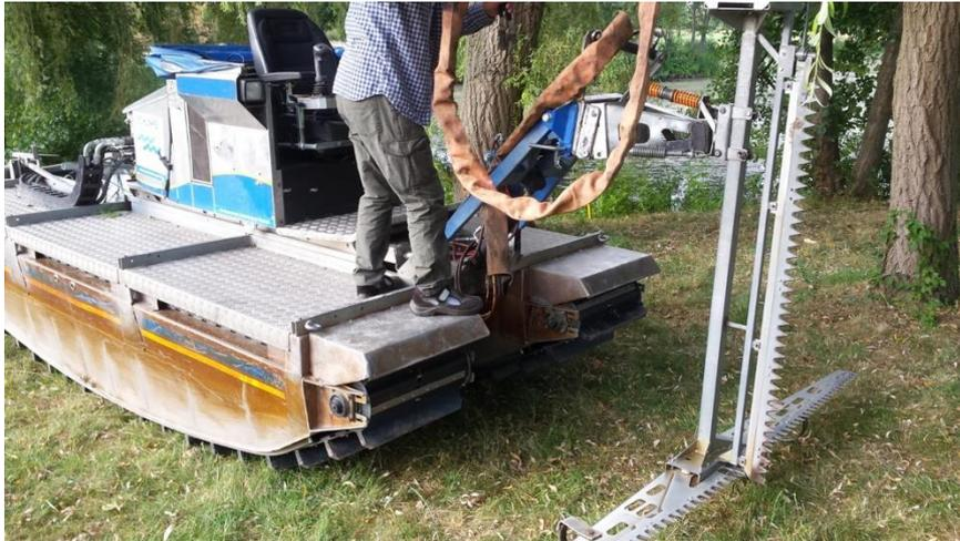
Mit einem speziellen Amphibienfahrzeug wurde die Wasserpest am Teichgrund abgemäht und aus dem Wasser befördert. Diese wurde zuerst am Teichufer zwischengelagert, um darin enthaltenen Tieren die Rückkehr ins Wasser zu ermöglichen.
